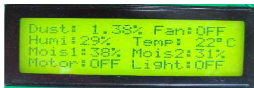
[그림 8] 제어보드의 LCD 출력 화면
