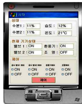
[그림 5] 모바일 단말기를 이용한 원격제어용 GUI 화면
