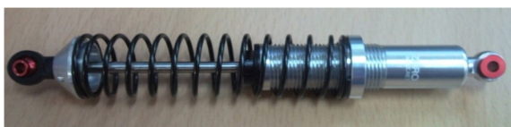
Fig. 4. 주퇴 시스템 축소 모델에 사용된 댐퍼, 스프링
