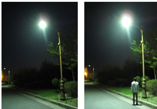
(a) 패턴 점등상태 (b) 전체 점등상태 그림 11. LED 가로등의 필드 실험 Fig 11. The field test of LED streetlight
