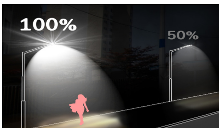
그림 4. 가로등의 동작 모듈 시뮬레이션 Fig 4. The streetlight activity module simulation
