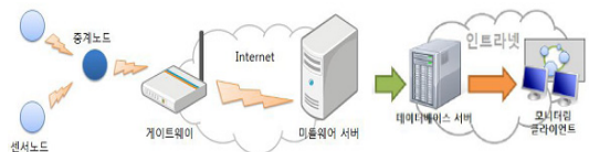
[그림 1] USN 기반의 악취 유발 물질 배출원 감지 모니터링 시스템
