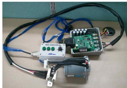
그림 5. 모터 제어기 및 모터 사진.
