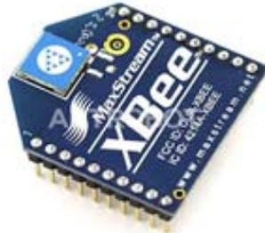
그림 7. 통신 모듈 Xbee
