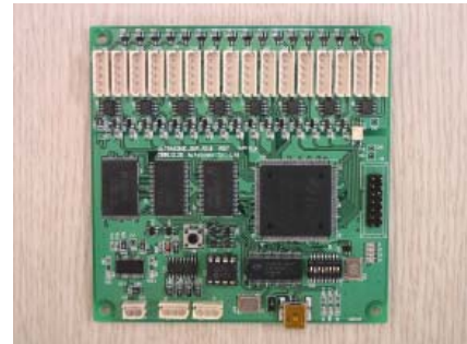
그림 4. 주제어 보드. Fig. 4. Main controller board.
