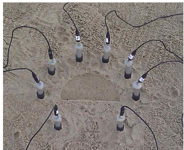
그림 3. 8개의 마이크 진원 센서를 이용한 실험 사진.
