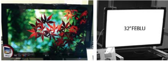
(그림 7) 32"급 전계방출 백라이트 및 이를 채용한 32"급 LCD TV
