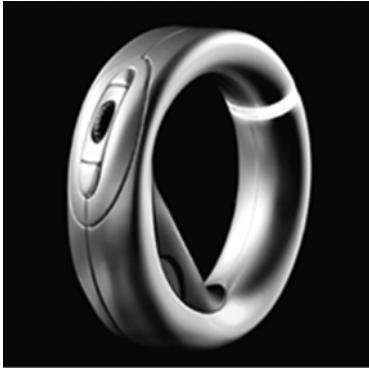
(그림 4) 자유공간 공중 관성 센서 기술을 이용하는 장치
