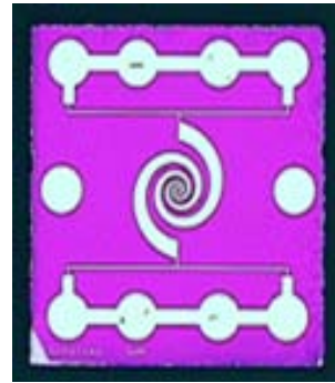
(그림 7) ETRI에서 제작한 안테나 집적 InGaAs SBD
