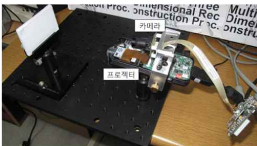
그림 10. 초소형 3차원 스캐닝 시스템의 구성. Fig. 10. Components of a micro 3D scanning system.
