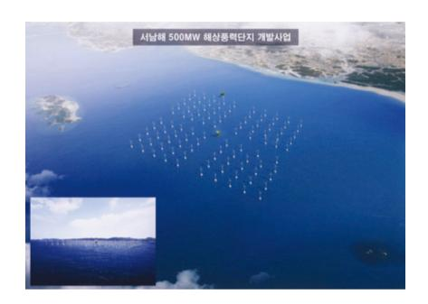
서남해 해상풍력 사업은 시행착오 최소화와 체계적이고 효율적인 추진을 위하여 실증, 시범, 확산의 3단계로 구분하여 추진된다. 먼저 100MW 규모의 실증단지를 구축하여 우리 기술로 만든 풍력터빈 및 기초 구조물 등에 대한 성능평가 및 실증을 거쳐 400MW 규모의 시범단지를 구축하고, 시범단지 운영모델을 기반으로 2GW 규모의 확산단지를 구축하는 순으로 계획되어 있다.
