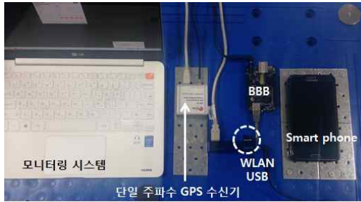
그림 11. 온보드 모듈과 지상 모니터링 시스템의 구성 및 외형. Fig. 11. Configuration and appearance of onboard module and ground monitoring system.
