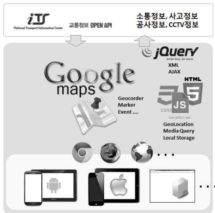
그림 3. 실시간 교통정보 웹 시스템 흐름도. Fig. 3. Flow for real-time traffic information web system
