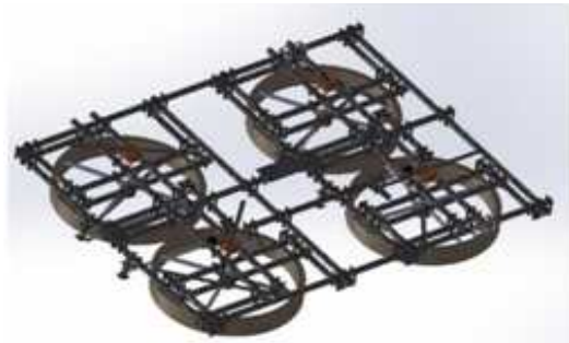
그림 3. 직사각형태의 비대칭 동력원 배열을 가지는 X8 로봇의 3D 모델. Fig. 3. X8 Robot 3D Model of Rectangular-type Asymmetric Actuator Placement.
