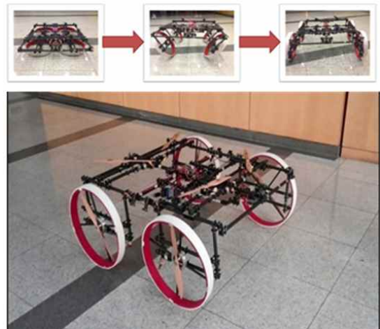
그림 11. X8 Copter에서 자동차 변신 과정. Fig. 11. X8 Copter-to-Car Transform Process.
