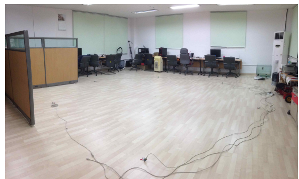
그림 3. 배치된 진동 감지 회로와 실험환경의 모습. 5m 지름의 원에 60도 간격으로 센서들을 배치하여 그 안에서 일어나는 걸음걸이 진동을 측정하고 그 위치를 추정하는 실험을 진행하였다.
