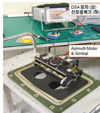
그림 18. Gimbal ANF적용, 공진발생 여부 측정환경(가속도센서+DSA).
