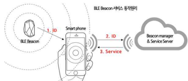
그림 1. Beacon의 서비스 동작 원리 Fig. 1. Operating principle of Beacon service
