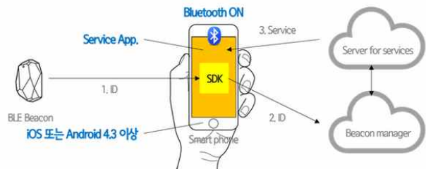
그림 2. Beacon 서비스 동작 흐름 Fig. 2. Operating flow of Beacon service
