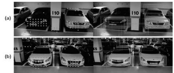
그림 5. CNN을 이용한 차량 전면부 검출 결과. 왼쪽은 분류 신경망의 결과(탐색된 윈도우의 중심점만 표시), 오른쪽은 위치 추정 신경망의 결과.
