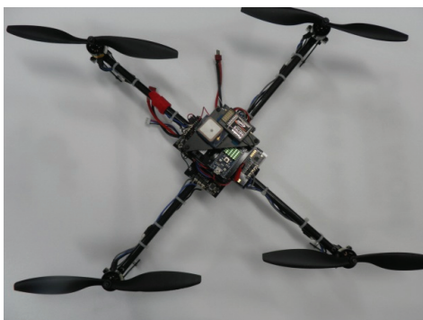
그림 2. 비행제어시스템이 탑재된 쿼드로터 비행체. Fig. 2. Quad-rotor Flying robot with flight control system.
