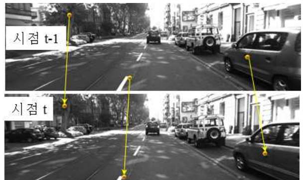
그림 5. 자차량 모션에 의한 영상의 변화. Fig. 5. Change on the images by the motion of ego-vehicle.
