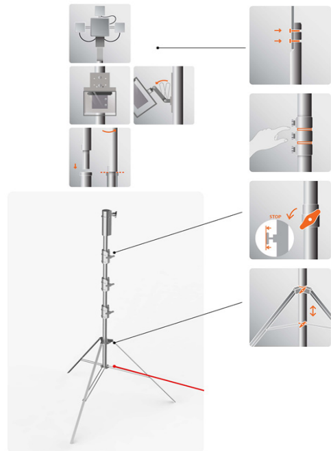
그림 1. 이동식 검지대 구조 Fig. 1. Structure of Portable Detector
