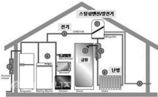
그림 7 가정용 열병합발전 개념도(왼쪽), 전기발전 보일러 상용제품, Baxi, KD Navien(오른쪽)
