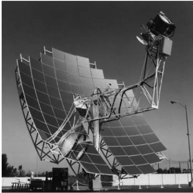
그림 6 태양열 이용 3 kW 스텔링 컨버터, infinia(왼쪽), 발전 단지, Boeing, Kockums(오른쪽)
