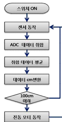
그림 8. 프로그램 흐름도 Fig. 8. Program flow chart
