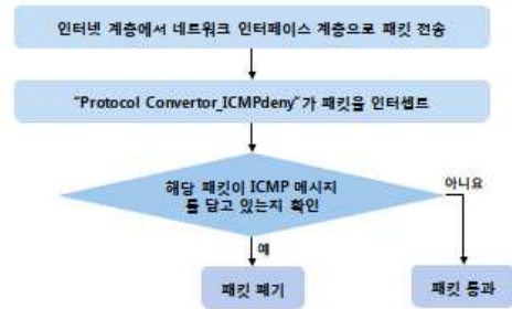
<그림 1> Protocol Converter_ICMPdeny의 알고리즘
