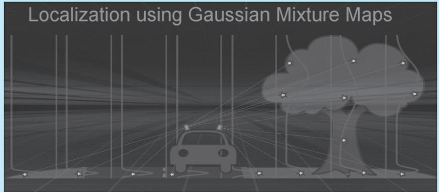
그림 4 가우시안 혼합 모델을 이용한 차량 정밀 측위(포드, GTC 2016)
