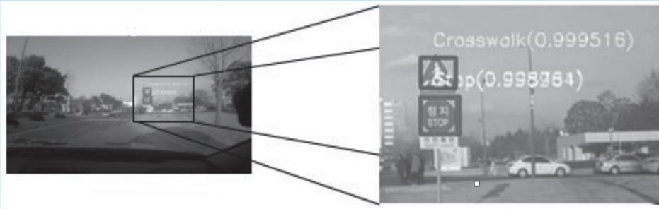
그림 2 심층 컨볼루션 신경망을 이용한 표지판 탐지
