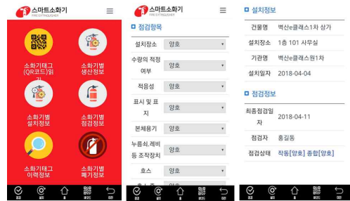
<그림 6> 스마트소화기 통합 앱과 설치 및 점검 정보
