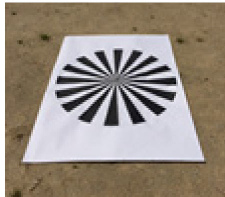
그림 6. 검증에 사용한 대공 표지 Fig. 6. Signal Chart used for Verification
