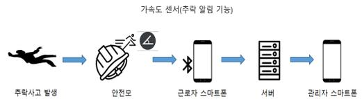
그림 5. 가속도 센서를 이용한 추락 알림 기능
