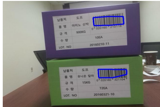
그림 8. 바코드 다중 인식 결과 Fig. 8. Barcode multiple recognition result
