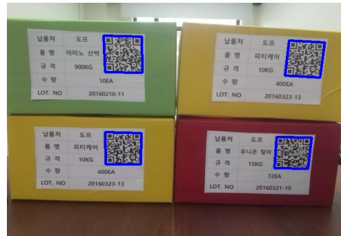
그림 9. QRcode 다중 인식 결과 Fig. 9. QRcode multiple recognition result
