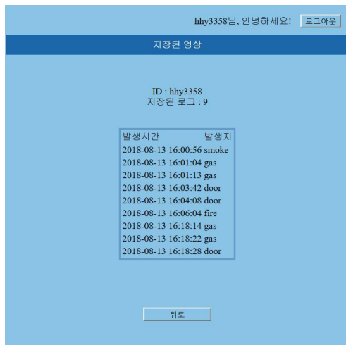
그림 11. 어플리케이션 실행 화면 (로그 페이지) Fig. 11. Execution Screen of Application (Log Page)
