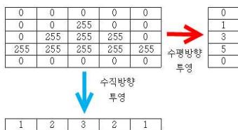
그림 6. 투영 히스토그램 생성 과정 Fig. 6. Computation of the projection histogram.
