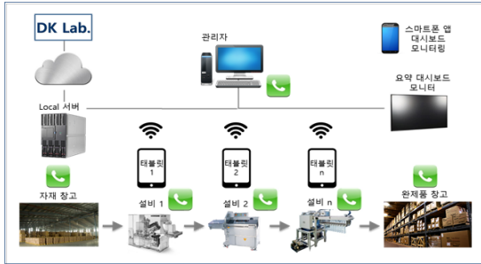
그림 2. 공정별 배치의 예 (시각화용 태블릿PC 설치) Fig. 2. Example of process-specific layout (with visualization tablet PC)
