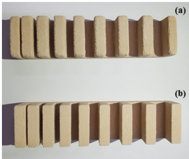
그림 6. DPI에 따른 출력 결과 (a) 300DPI (b) 600DPI
