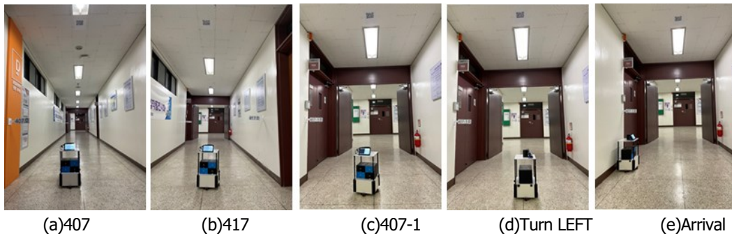
(a)407 (b)417 (c)407-1 (d)Turn LEFT (e)Arrival Figure 11. The transport robot driving experiment when the destination direction is only going straight 그림 11. 목적지 방향이 직진만 있는 경우 운반 로봇의 주행 실험
